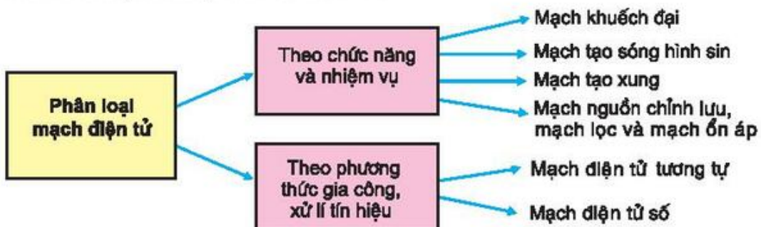
Hình 7 – 1. Sơ đồ phân loại mạch điện tử
