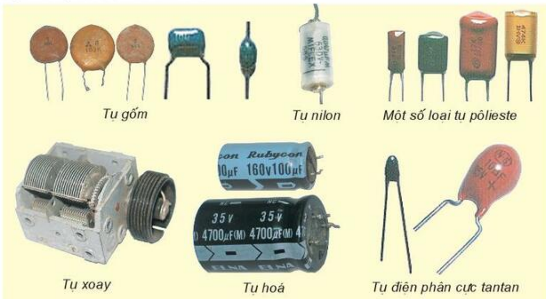
Hình 2 – 3. Hình dạng một số loại tụ điện
