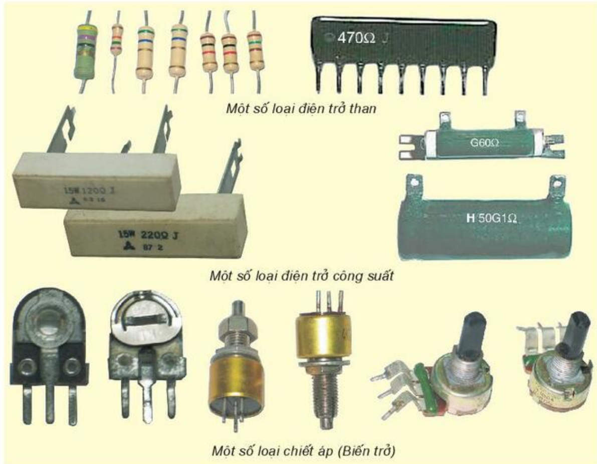
Hình 2 - 1. Hình dạng một số loại điện trở, chiết áp
